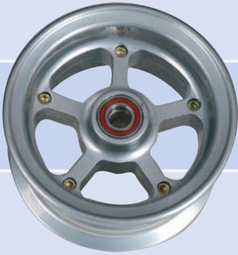
K-106A-000 Nose wheel 6" standard/ Bugrad 6" standard Weight/Gewicht: 1.010 g Price/Preis: 190,- EUR
